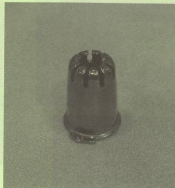
鼻毛カッターの外刃。順送金型で全体の形を絞り加工した後、サイドカム方式で溝入れを行う。従来の焼結金属(MIM)に研磨を施す工法に比べて1/4のコストダウンに成功。 株式会社大垣精工 ( http://www.ogakiseiko.co.jp )
